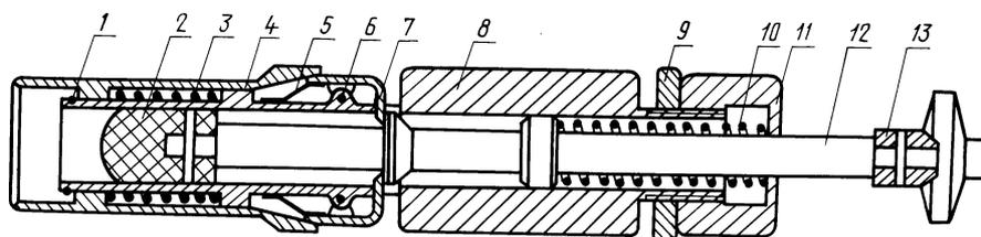
1 — кольцо стопорное; 2 — наконечник; 3 — пружина; 4 — головка; 5 — пружина;
