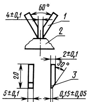
1 — электрод; 2 — испытуемый образец; 3 — конец электрода скруглен
